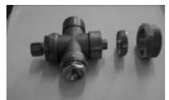
Raccord de sortie du champ capteur équipé d'un purgeur manuel et un doigt de gant pour sonde de température A raccorder à un tuyau en cuivre de diamètre 18mm
